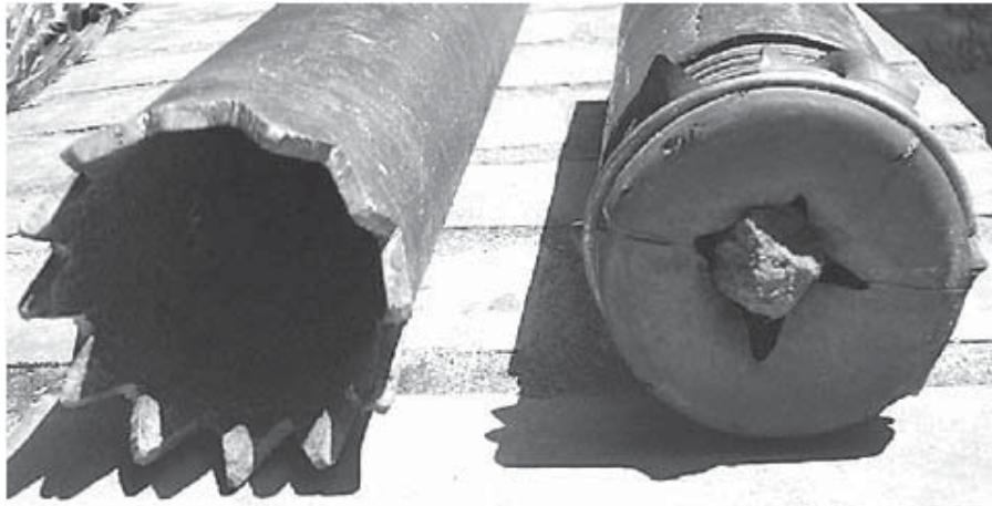
Figura 4. Fragmentador - Recuperador (Bosio, J. J.,1990)
