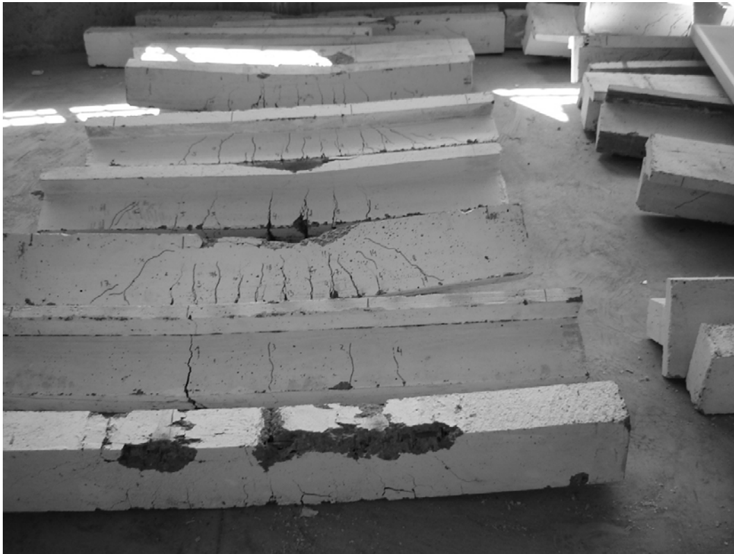
Fig. 10. Vigas construidas y ensayadas por alumnos en hormigón I.
