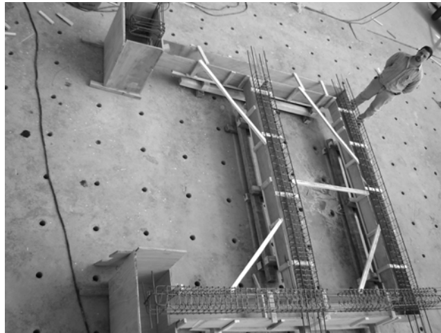
Fig. 11. Construcción de un Pórtico de hormigón armado para ensayo a cargas horizontales. Se observa la grilla de 50x50cm para anclaje de las bases de las columnas en la losa .
